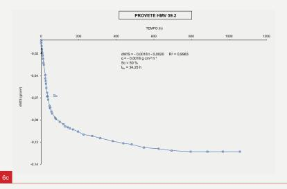
6 | Resultados de ensaios petrofísicos. a) Famílias principais de fissuras obtidas com o porosímetro de mercúrio na placa HMV 41; b) Curvas de absorção de água por capilaridade no provete HMV 59.2; c) Curva de evaporação do provete HMV 59.2.
